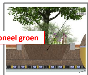
Straatboom incl. retentie &amp; capillair irrigatiesysteem
